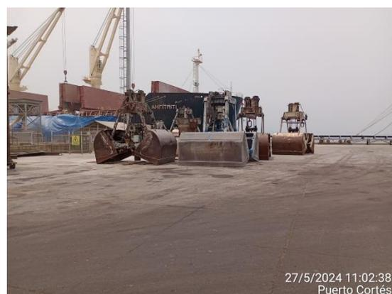
Almejas metálicas para realizar descargas de granos que vienen en las bodegas de los barcos.
