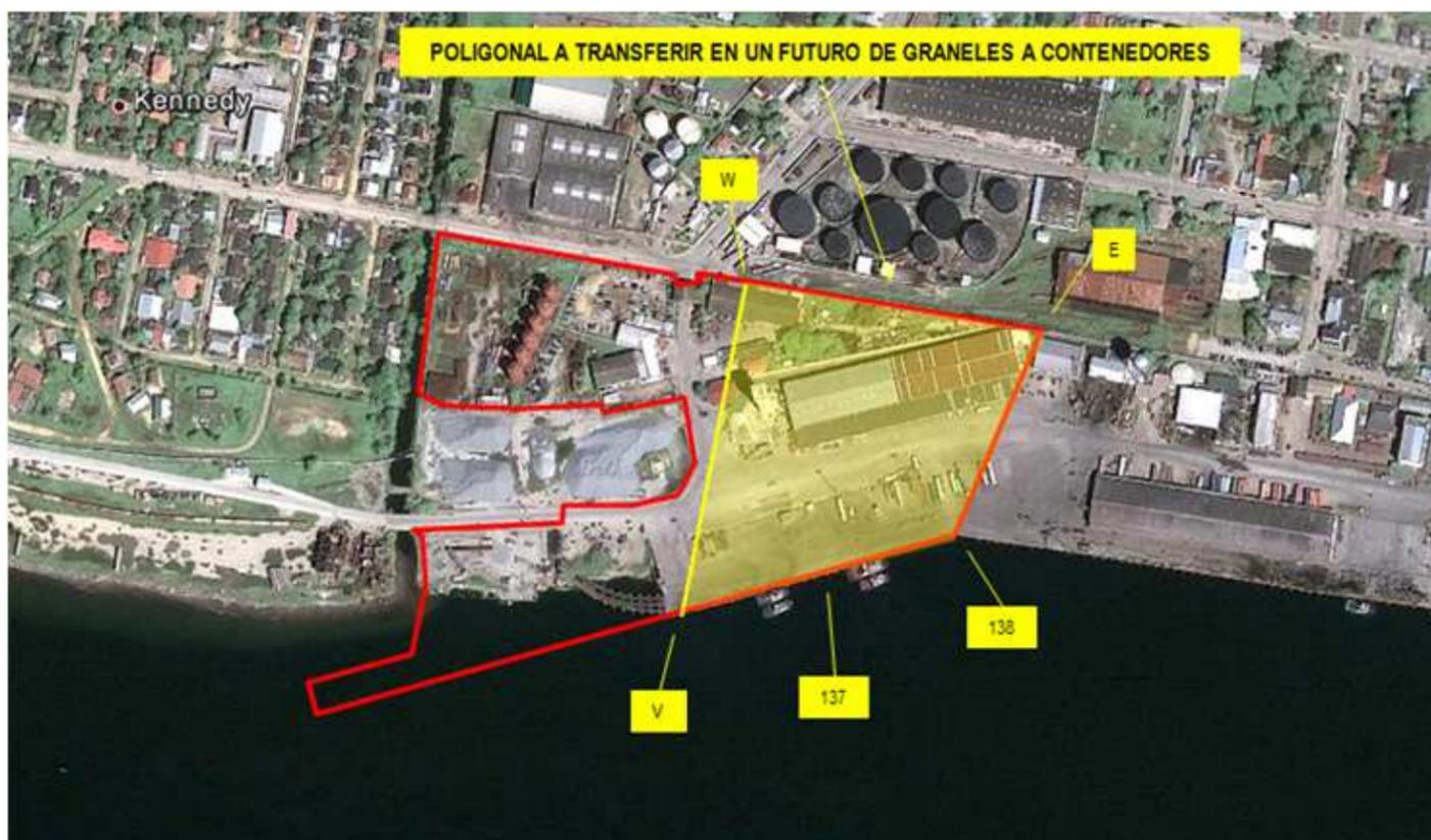
**Descripción de poligonal:** Estación 137, Coordenadas Y = 1751841.9481, X = 398129.1656; Estación 138, Coordenadas Y = 1751867.2865, X = 398214.7383; Estación E, Coordenadas Y = 1752004.7809, X = 398273.5610; Estación W, Coordenadas Y = 1751816.2450, X = 398037.3205; Estación V, Coordenadas Y = 1752037.0823, X = 398083.5874.
