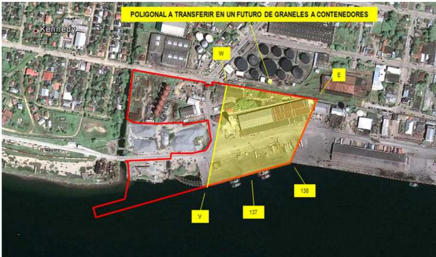
**Descripción de poligonal:** Estación 137, Coordenadas Y = 1751841.9481, X = 398129.1656; Estación 138, Coordenadas Y = 1751867.2865, X = 398214.7383; Estación E, Coordenadas
